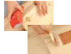
好みに合わせてヤスリで角を丸めたり、木工用塗料などで風合いを出す。
