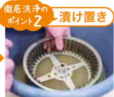
徹底洗浄のポイント2 漬け置き 取り出したパーツをプロ仕様の洗剤液に漬け、汚れをキレイに洗い流します。
